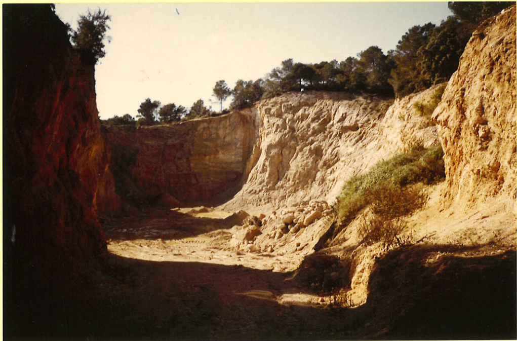
1023. Carretera de Maó a Ciutadella bifurcación Cala Pilar. Cantera de explotación de dolomías del Lías para áridos.
